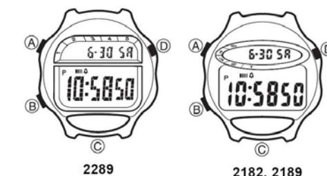
На рисунке изображен общий вид часов в режиме Текущего времени. Нажмите кнопку "В" для перехода из режима в режим в следующей последовательности:
