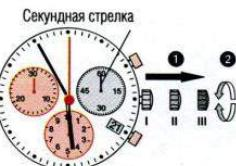
Чтобы синхронизировать маленькую секундную стрелку, находящуюся у отметки 2 часа, с сигналом точного времени (радио/ТВ/Интернет), вытяните заводную головку до второй метки в момент её прохождения через отметку 12 часов; стрелка остановится. Как только прозвучит сигнал точного времени, верните головку в положение I (и завинтите ее, если Ваша модель снабжена завинчивающейся головкой).
