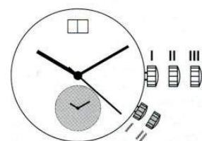
Чтобы синхронизировать маленькую секундную стрелку, находящуюся у отметки 2 часа, с сигналом точного времени (радио/ТВ/Интернет), вытяните заводную головку в положение II в момент её прохождения через отметку 12 часов; стрелка остановится.
