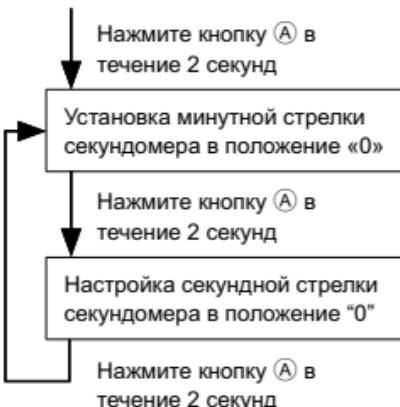
Минутная стрелка секундомера сделает полный круг, чтобы подтвердить готовность к настройке. Нажмите кнопку B для переустановки ее в положение «0».
