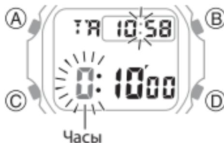
3. С помощью кнопки В выполните настройку часов работы таймера.
