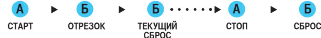
\* Нажав на кнопку Б, вы можете измерить и сбросить показания отрезка времени.
