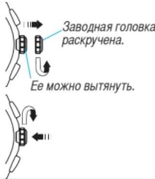
1. Перед погружением проверьте, что заводная головка плотно зафиксирована на месте.
