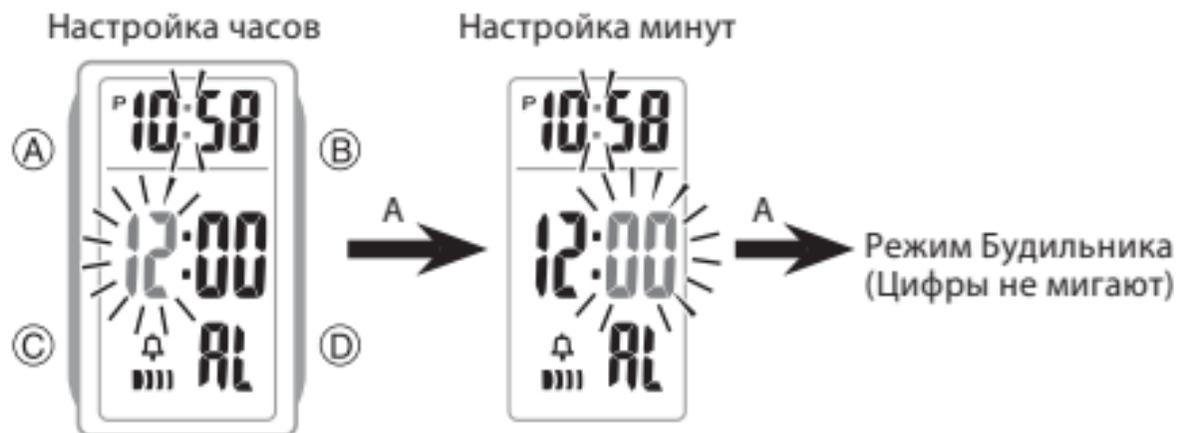
3. С помощью кнопки D выполните настройку выбранного параметра. Для ускоренной настройки выбранного параметра, удерживайте кнопку D нажатой.
