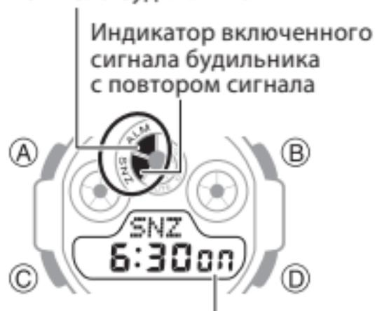
Индикатор включенного сигнала будильника с повтором сигнала
