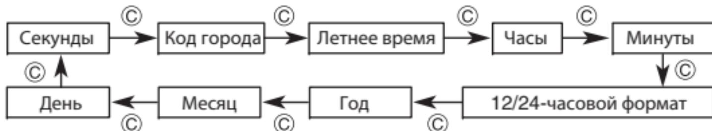
3. С помощью кнопок D или В выполните настройку выбранного параметра, как указано в таблице ниже.
